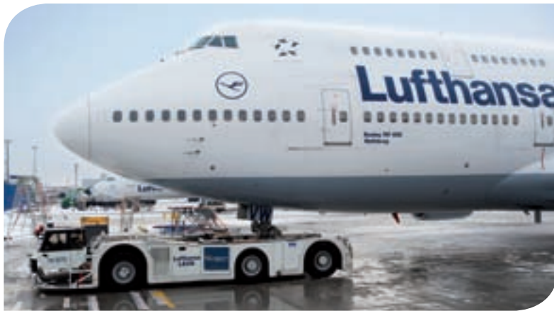
Umfangreicher Testlauf mit einem zum TaxiBot-Versuchsfahrzeug umgebauten LEOS-Schlepper am Flughafen Frankfurt
