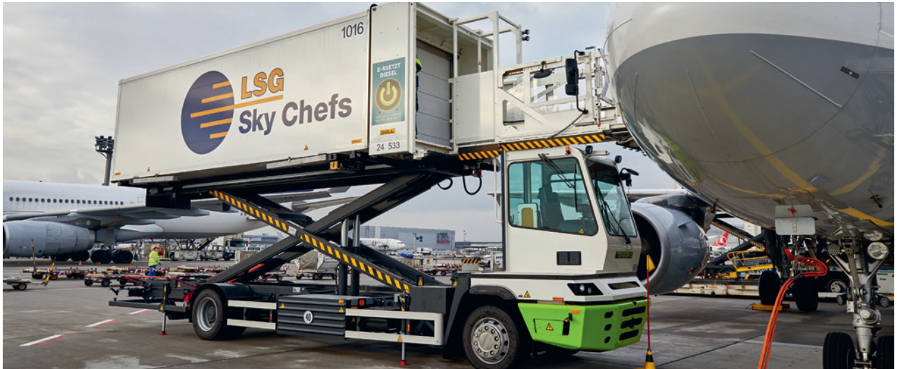
Die LSG Group entwickelte bei E-PORT AN in enger Zusammenarbeit mit externen Partnern den vollständig elektrifizierten Catering-Hubwagen "eLift".
